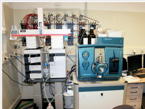
Analysegerät zur qualitativen und quantitativen Bestimmung von Biozid- und PSM- Wirkstoffen. Sensitive measurement instruments (LC_MS/MS) for qualitative and quantitative detection of residues.
