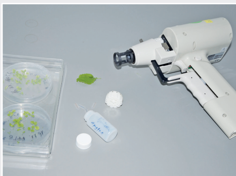
„Partikelkanone“ für die technische Übertragung von Genen zwischen unterschiedlichen Organismen. Gene gun used for the technical transfer of genes between different organisms.
